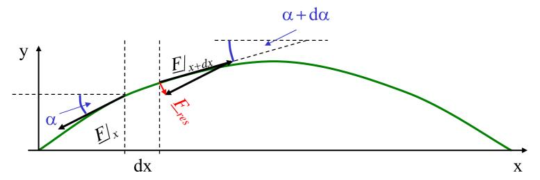
am Beispiel der schwingenden Saite: Die Kräfte F an einem kleinen Saitenstück sind vom Betrag gleich (F<sub>0</sub>) aber nicht genau entgegengesetzt (siehe Abb.). Die Krümmung der Saite erzeugt Kraftkomponente <u>F</u><sub>res</sub> senkrecht zum Saitenstück.
