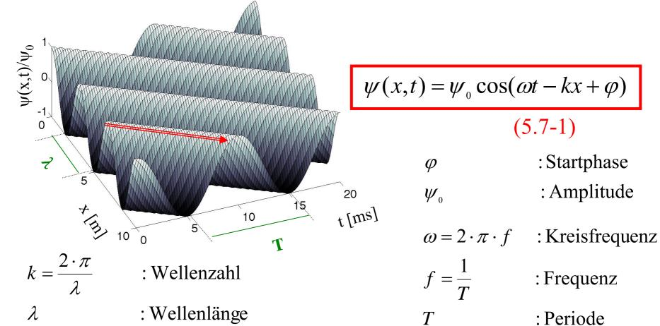
Phasengeschwindigkeit: Geschwindigkeit mit der sich eine bestimmte Phase fortbewegt (z.B. Pfeil in Abbildung)
