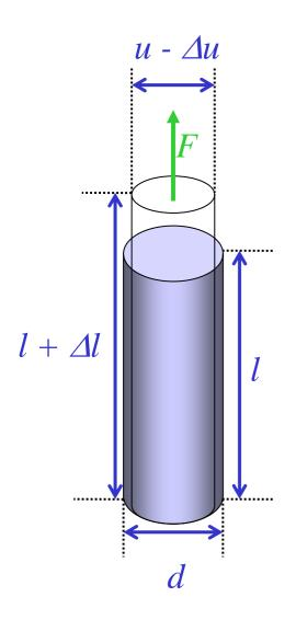
Experimentell: Relative Stabänderung bei Zugkraft ist proportional zur anliegenden Kraft F und entgegengesetzt proportional zur Querschnittfläche A: Hookesches
