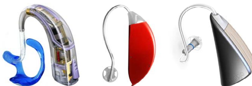
Abb. 4: Hinter-dem-Ohr-Hörgeräte mit individueller Otoplastik (links, transparent zur Darstellung der Komponenten), offenem Standardohrstück (Mitte) und ausgelagertem Hörer im Gehörgang (rechts).
