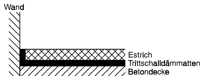
Abbildung 5.8: Aufbau des "schwimmenden Estrichs"
